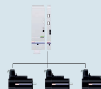
Acionamentos para recuperação de energia durante frenagem
